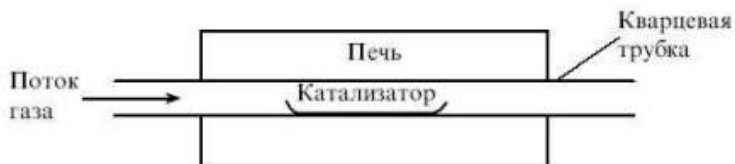
Рис. 1 – Общая схема установки, используемая в методе CVD [1]
