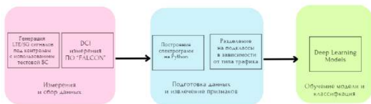
Рис. 1 – Схема использования DCI-данных и методов машинного обучения для задач классификации мобильного трафика
