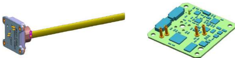
Рис. 1 – 3D- модель аварийного радиомаяка и печатной платы блока выдачи аварийного сигнала
